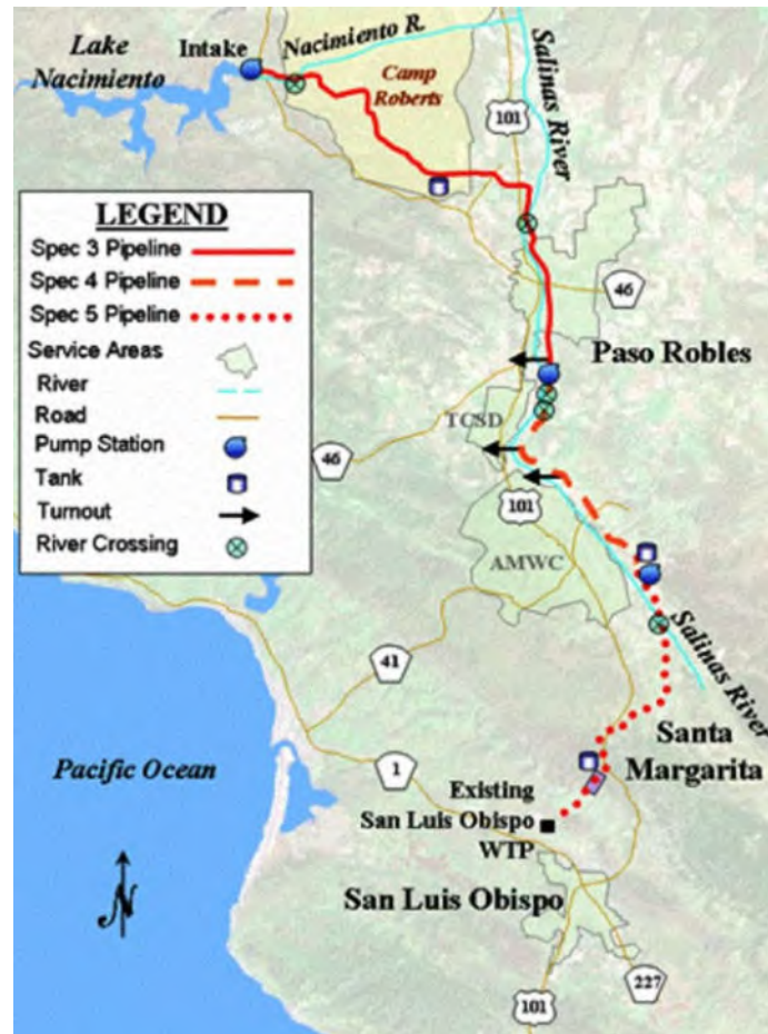
Figure 26. Nacimiento Water Pipeline
